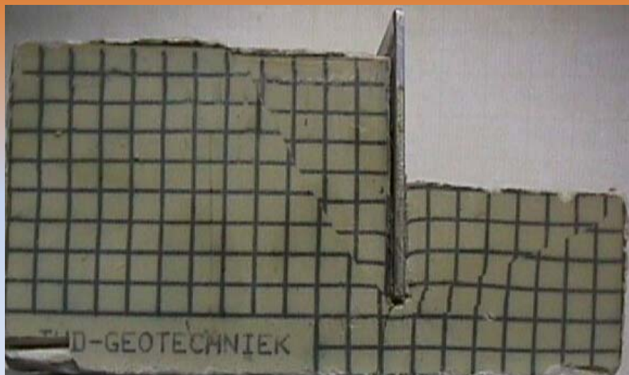
مطالعه آزمایشگاهی سپر با مدل فیزیکی
